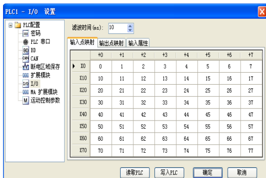
信捷PLC编辑软件I/O设置界面
